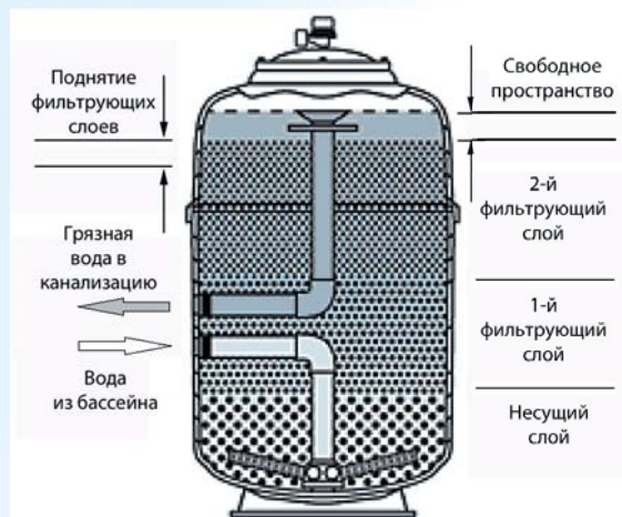
Рис. 4 Фильтр в режиме «обратной промывки»
