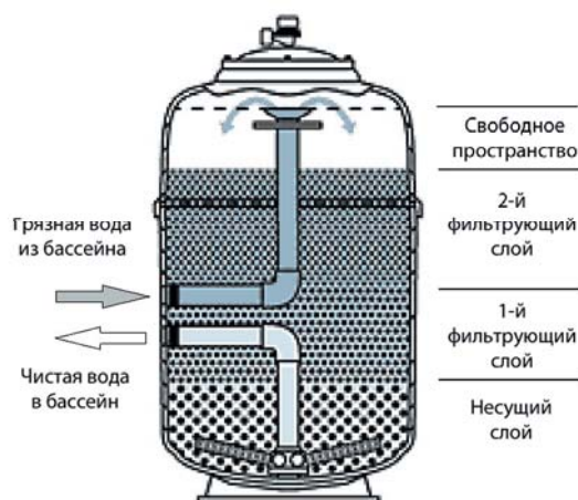
Рис.3 Фильтр в режиме фильтрации
